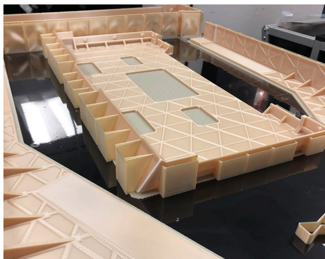
これらの3Dプリンタによる造形部品は、従来使用されていたラミネート複合材で製造されたアセンブリに取って代わるものである
