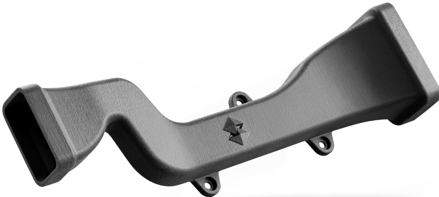
この自動車HVACシステムのエアダクト部品はSAF™技術で造形されています。従来、このような部品は2つの部分を成形してから組み立てられてきました。SAF技術により、1つの部品として造形できるため、後工程の組み立て作業と破損の発生を減らすことができます。
